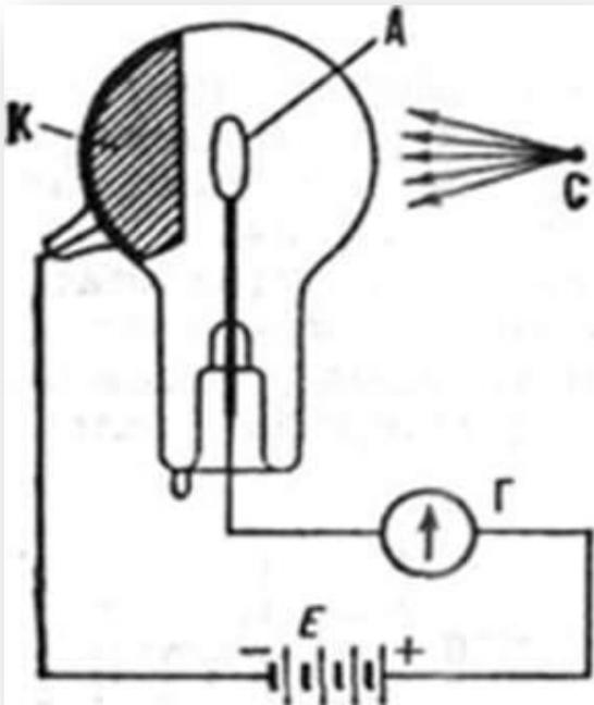
При попадании света на катод фотоэлемента в цепи возникает электрический ток, который включает то или иное реле.
