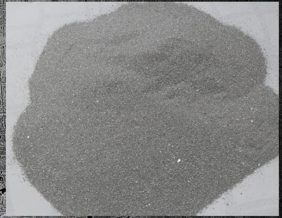
Магний – лёгкий серебристо-белый металл, блестящий, но тускнеющий на воздухе из-за образования защитной оксидной плёнки на его поверхности. Химическая формула магния – Mg. 12 – атомный номер магния в периодической системе химических элементов Д.И.
