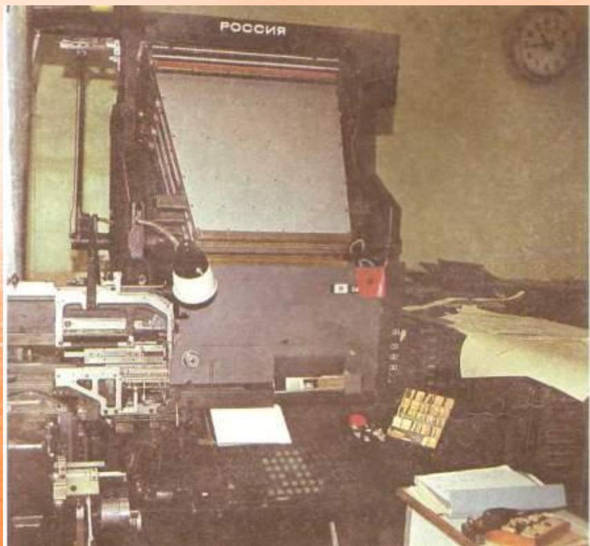
Книг требовалось всё больше и больше. И тогда на помощь человеку пришли умные машины. Одна из них строкоотливная наборная машина ЛОНОТИП.
