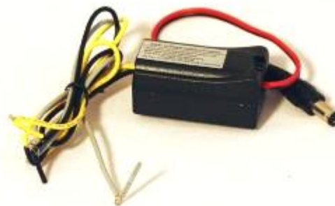
Кабель питания с конвертером напряжения Желтый провод – ВАТТ(АСС) +12V Серый провод – к лампе заднего хода Черный провод – «земля»
