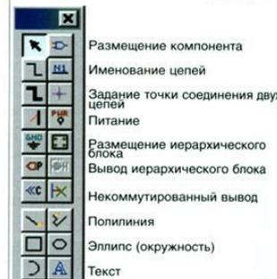
Рис. 2. Палитра инструментов редактора OrCAD Capture в режиме проектирования схем
