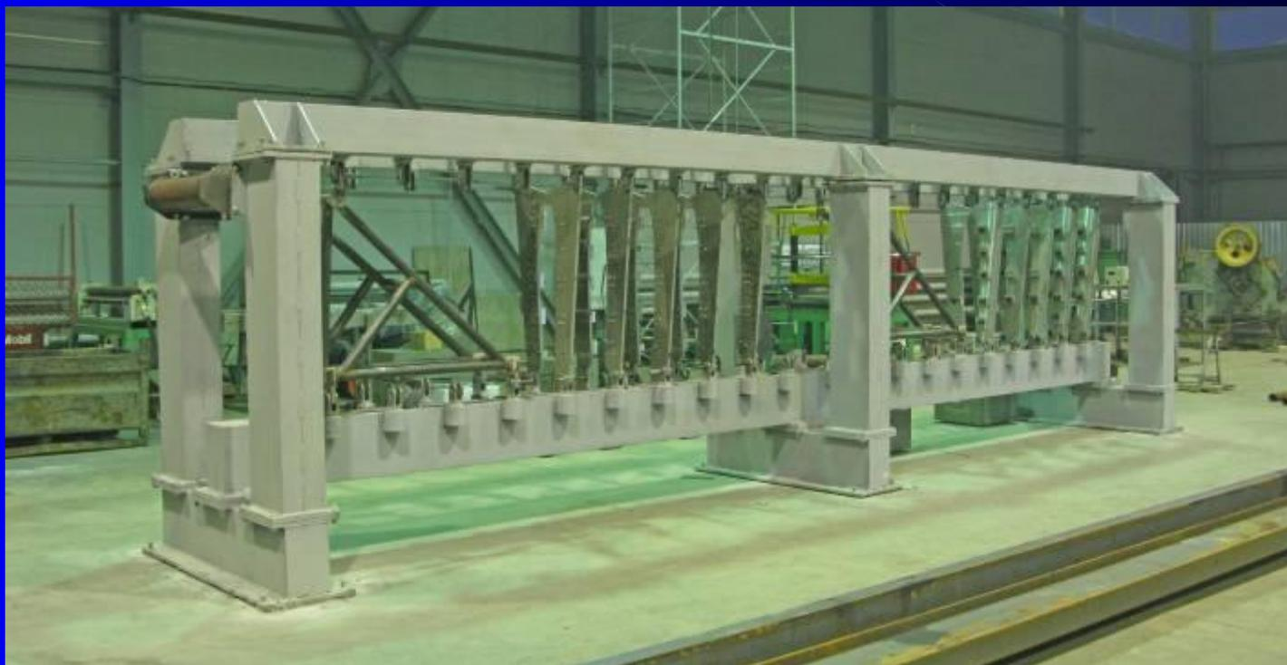
Стапель сборки стабилизатора учебного двухмоторного самолета
