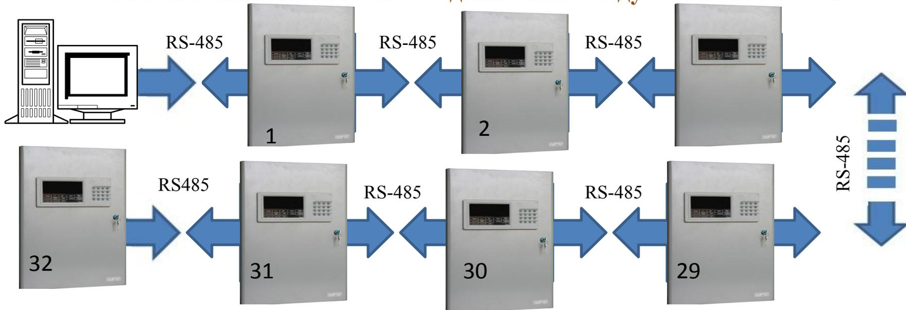
Максимальное количество модулей БВШ-3В, БВК- 8, БКН соединяемых между собой в одной системе не более - 30
