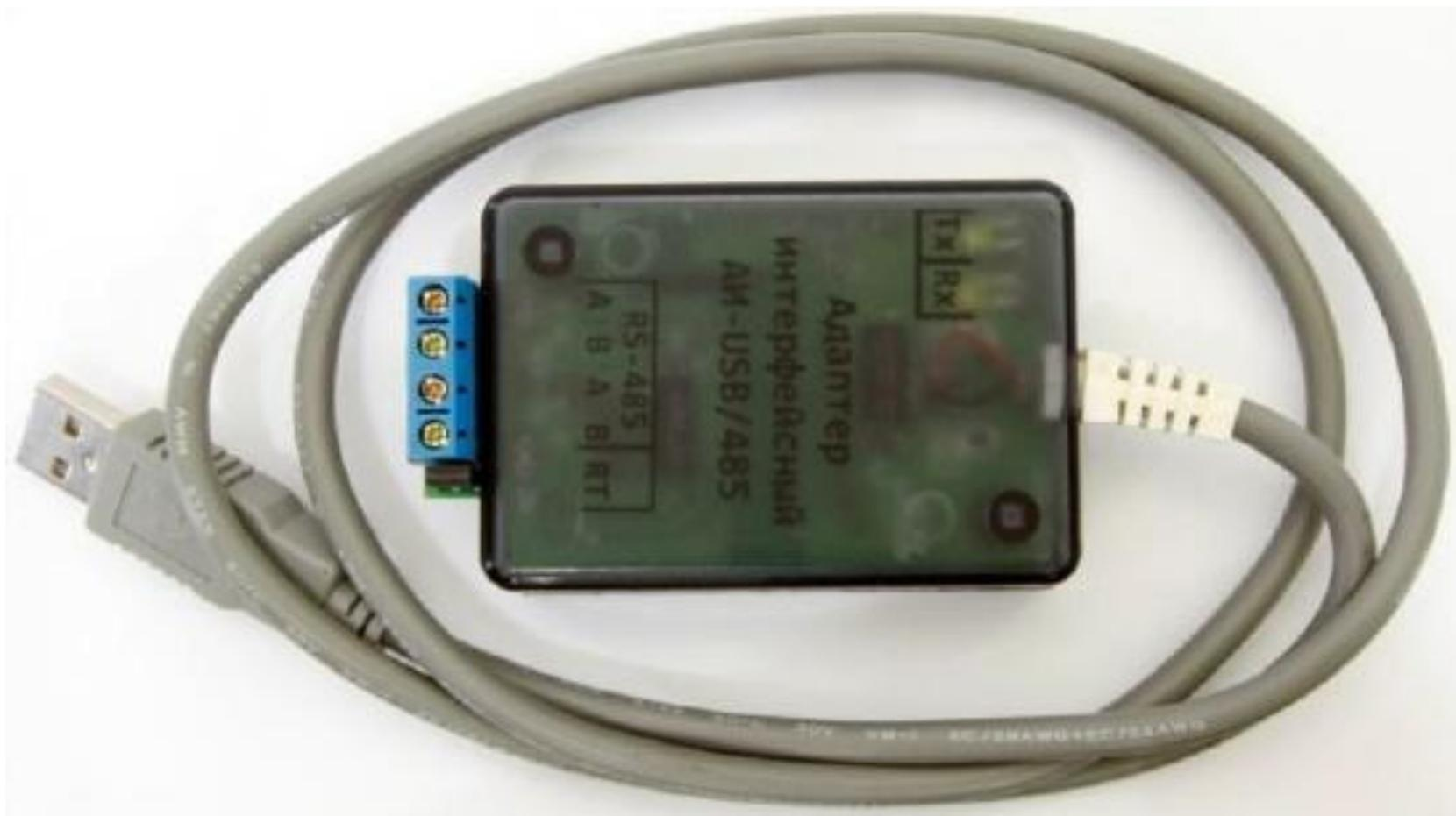
Адаптер интерфейсный «АИ-USB/485» предназначен для обеспечения связи и гальванической развязки ПК имеющего интерфейс USB, с удалёнными объектами по интерфейсу RS-485
