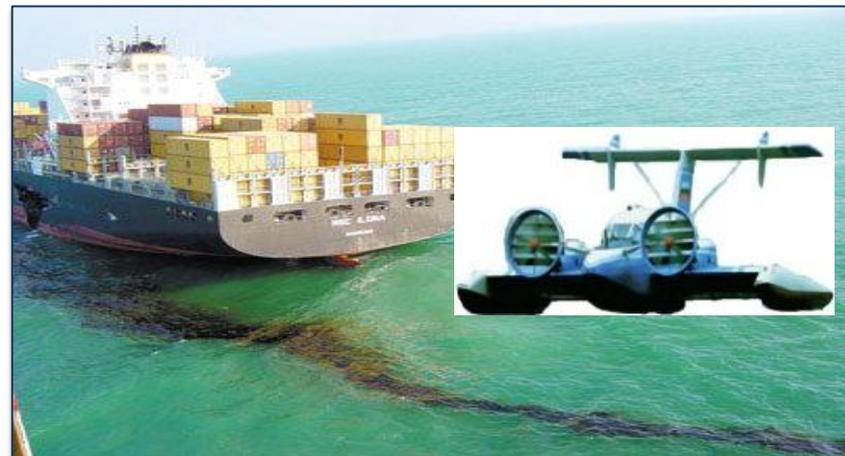
Мониторинг обстановки или перелет в район разлива осуществляется в основном режиме экранного полета. Постановка боновых заграждений осуществляется на режиме «глиссирование» на скоростях до 100 км/час
