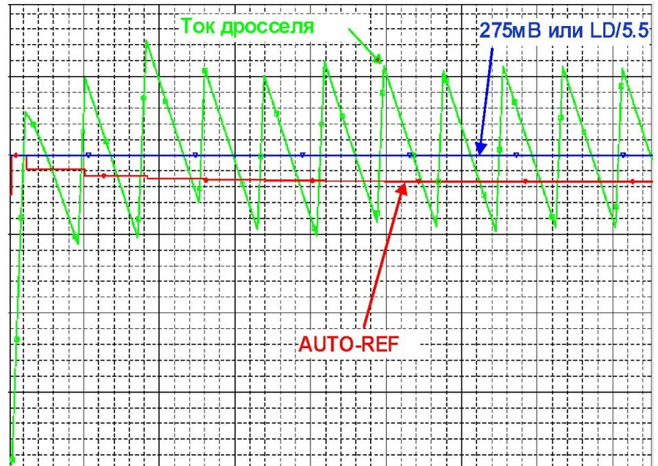
Авто-калибровка устраняет влияние задержки распространения и входного напряжения смещения компаратора CS.
