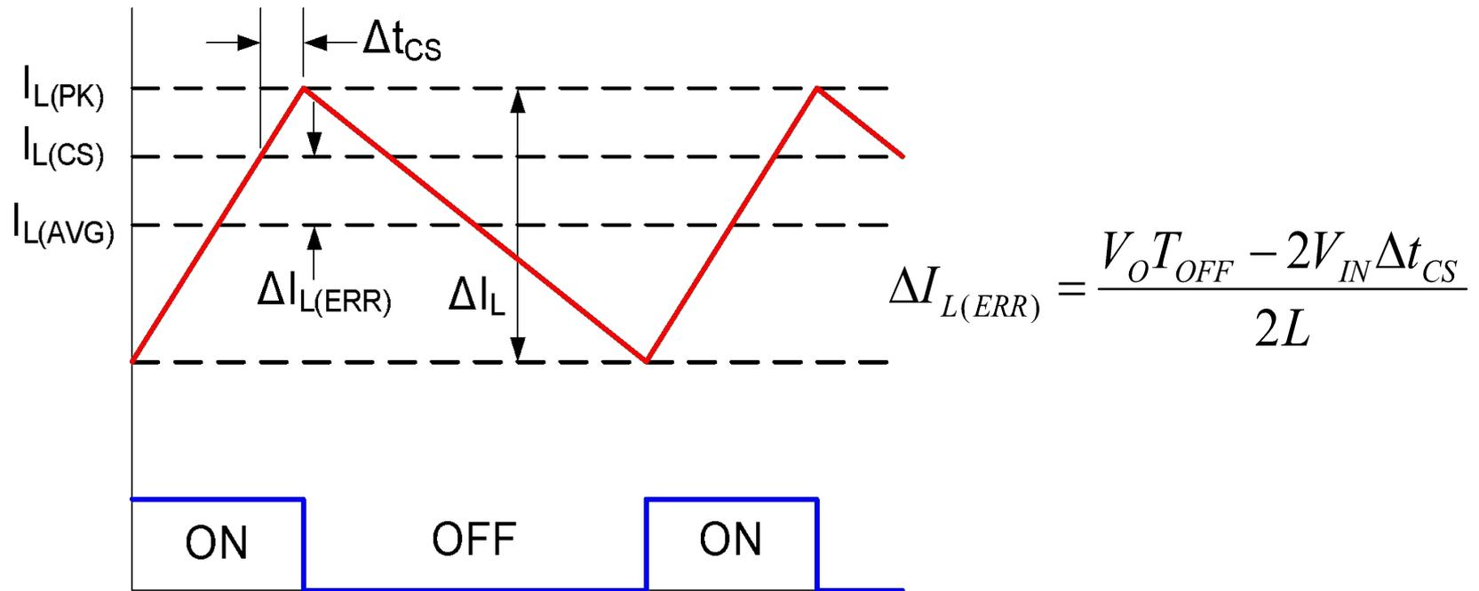
Ошибка выходного тока  $\Delta I_{L(ERR)}$  неотъемлемо присуща HV9910B, поскольку микросхема управляет пиковым током  $I_{L(PK)}$  в то время, как задача состоит в стабилизации среднего тока  $I_{L(AVG)}$ .
