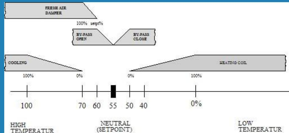
Запрос на нагрев и охлаждение регулируется в пределах от 0 до 100%. Последовательность включения органов управления представлена на рисунке.
