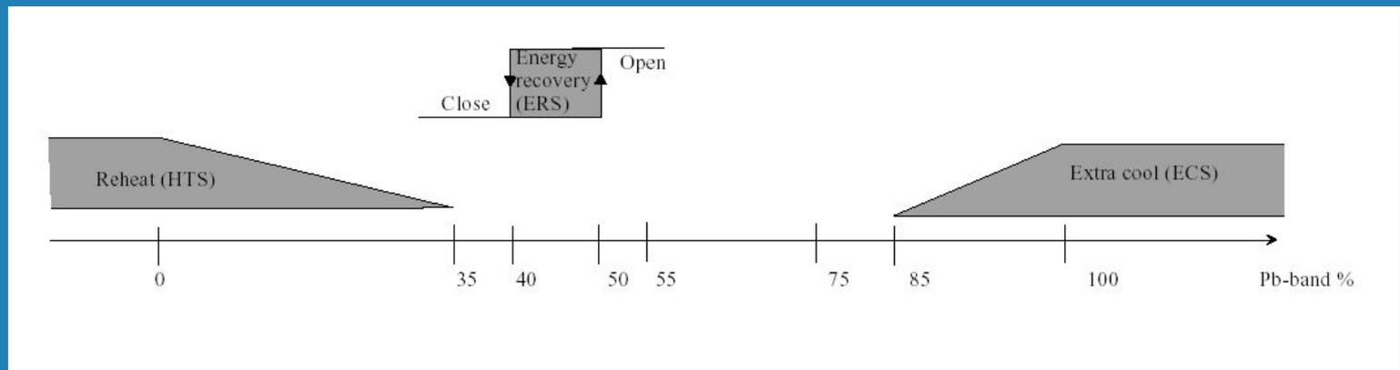
Запрос на нагрев и охлаждение регулируется в пределах от **0** до **100%**. Последовательность включения органов управления представлена на рисунке.
