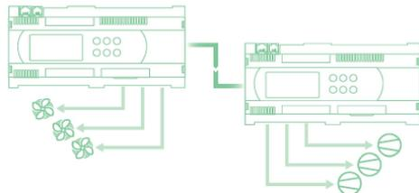
Возможность разделения управления компрессорами и вентиляторами при одном терминале пользователя и локальной сети между контроллерами.
