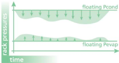
Работа с **плавающим давлением всасывания и конденсации** для повышения эффективности и производительности агрегата.
