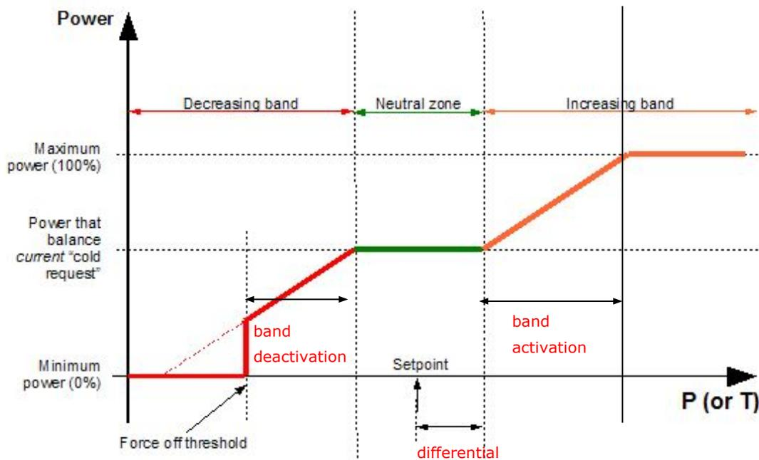
узкий диапазон □ системы с быстрой реакцией, возможны колебания
