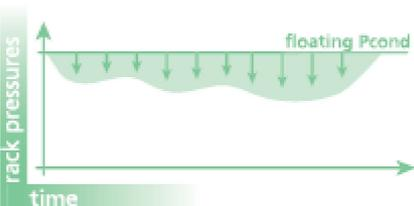
Работа с **плавающим давлением конденсации** для повышения эффективности и производительности компрессора агрегата.
