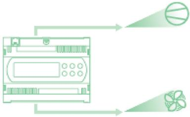
**Плавное регулирование мощности** используя специальный выход инвертера компрессора и/или инвертер/фазное регулирование выход для вентиляторов конденсатора.
