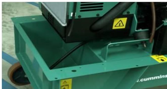
*Герметичная конструкция бака*
