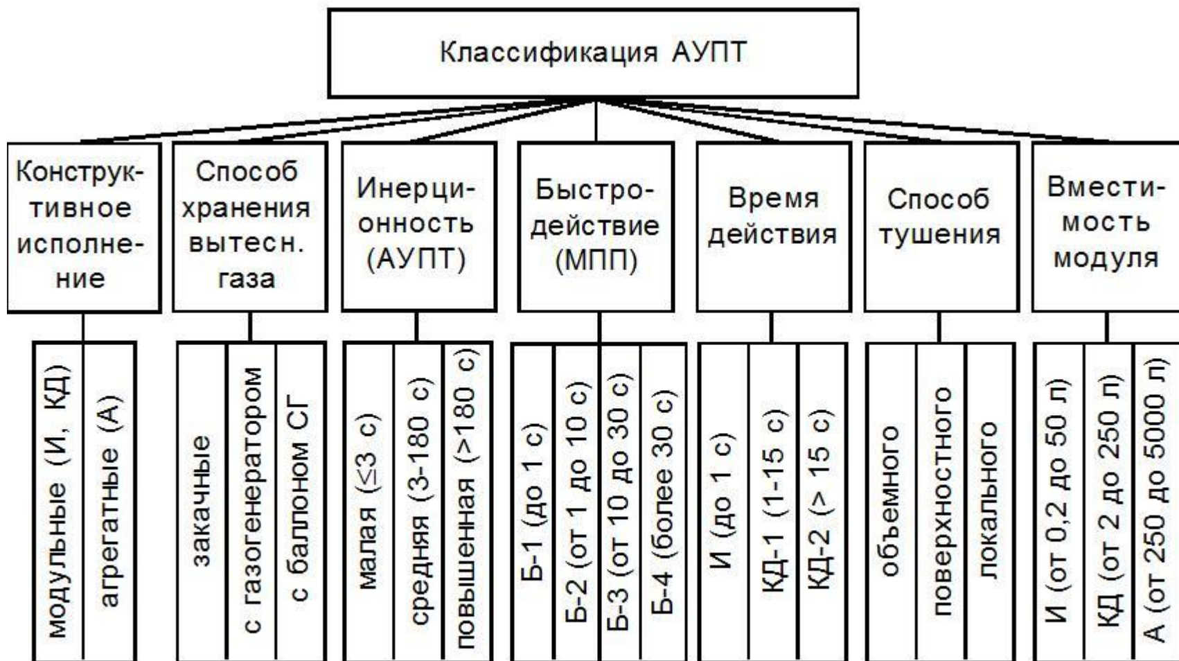
Рис. 2.5. Классификация автоматических установок порошкового пожаротушения по ГОСТ Р 51091-97
