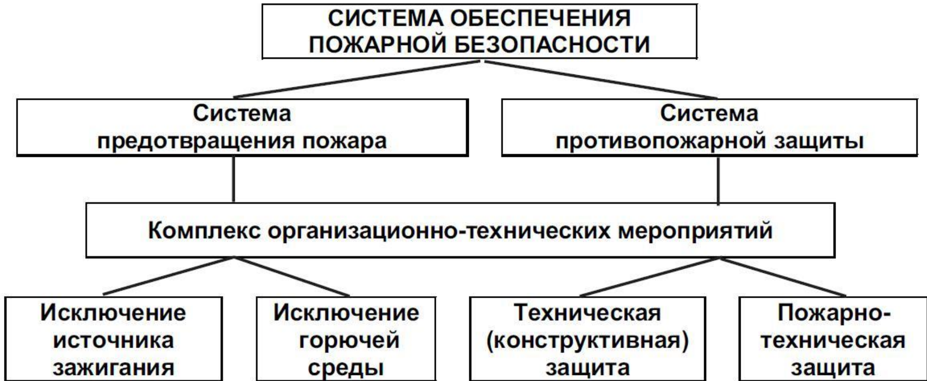
Рис. Система обеспечения пожарной безопасности объекта защиты
