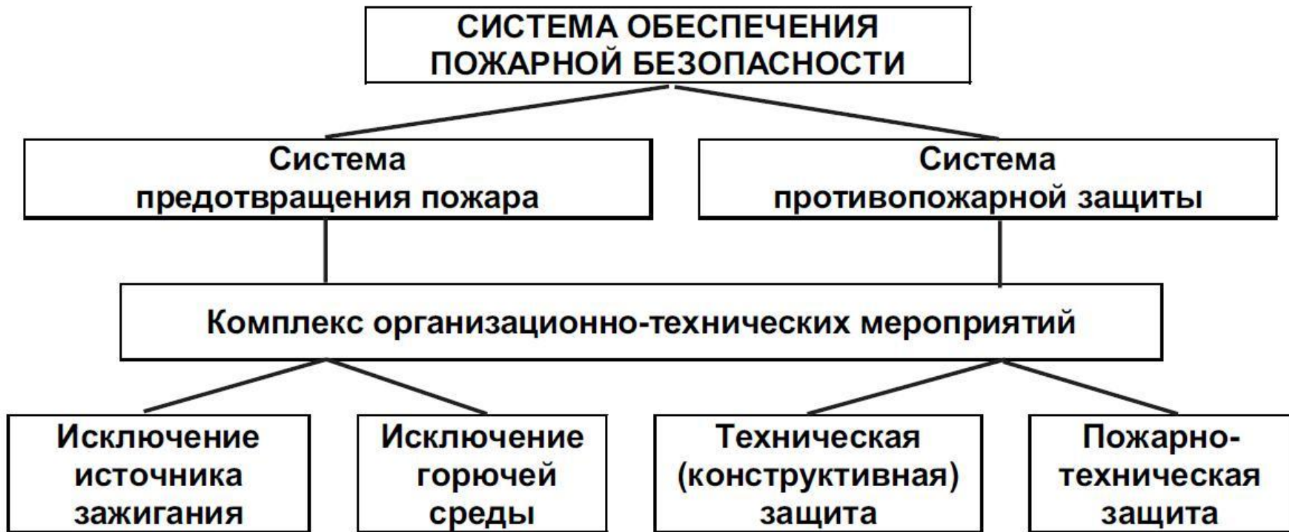
Рис. Система обеспечения пожарной безопасности объекта защиты
