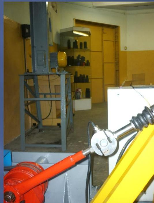
Испытания изделий на работоспособность проведены совместно с лабораториями Госстандарта РФ. В ходе проведенных испытаний пыльники и отбойники выдержали более 2 млн. колебательных циклов, что эквивалентно 5 годам эксплуатации автомобиля в режиме такси.
