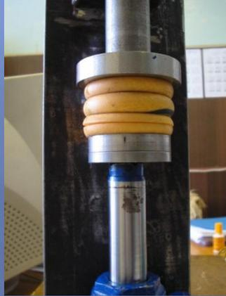
Стенды для проверки циклической долговечности
