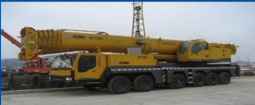
Автокран - грузоподъемность 130 т
