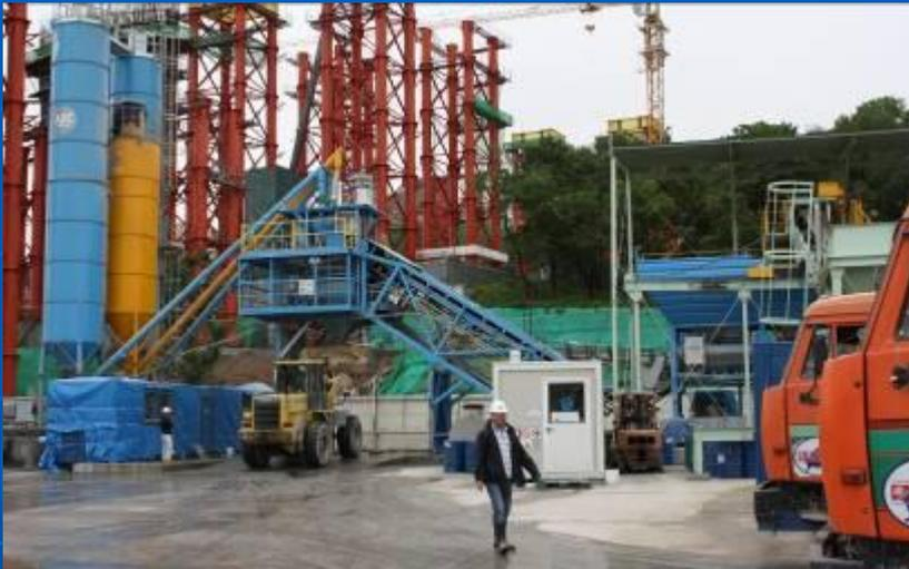
Стационарный бетонный завод
