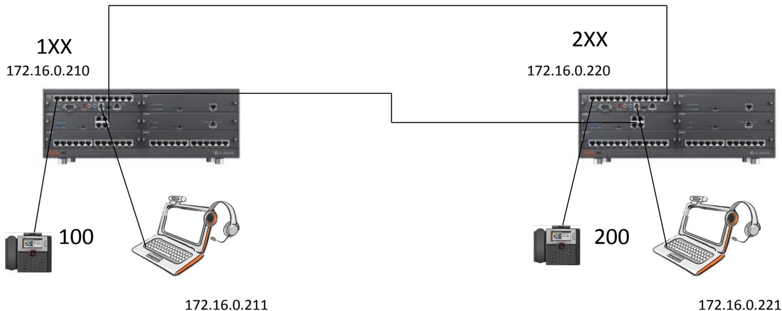
Соединить порт SLT6 на MPB (станция 1XX) с портом CO1 платы LCOB8 (станция 2XX). И наоборот.
