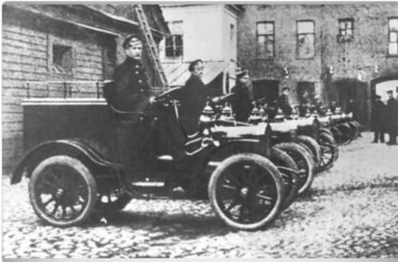
Почтовый автомобиль завода "Лесснер", 1905 г. скорость- 30 км/ч
