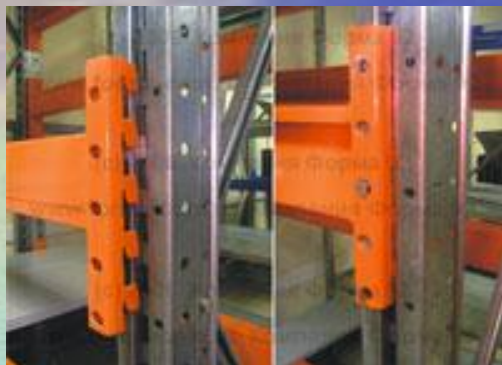
Крепление балок на крючках позволяет быстро изменять уровень балок
