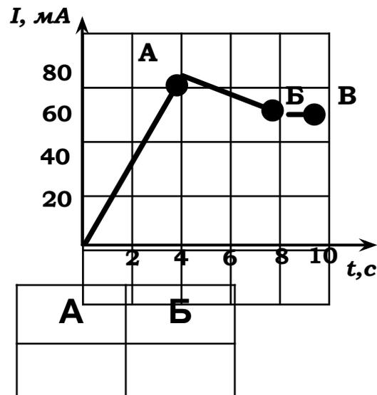
**№ 32.** На рисунке представлен график зависимости силы тока в катушке индуктивностью 10 мГн от времени. Установите соответствие между участками графика и значениями модуля ЭДС самоиндукции.
