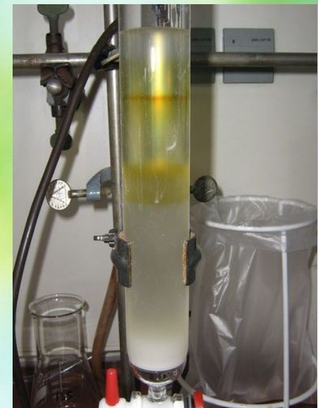
Множественная очистка от близких по химическому составу соединений
