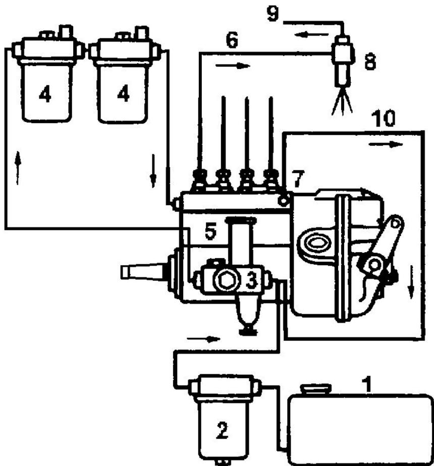
**Рисунок 3 - Схема топливной системы дизеля А-41СИ в составе трактора «Агромаш-90ТГ»**
