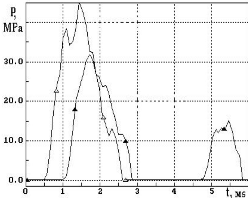
Рисунок 5 - Давление впрыска при безмоторном испытании и подогреве топливопровода: температура топливопровода + 35°C; температура топливопровода + 180°C; t – время процесса, ms.
