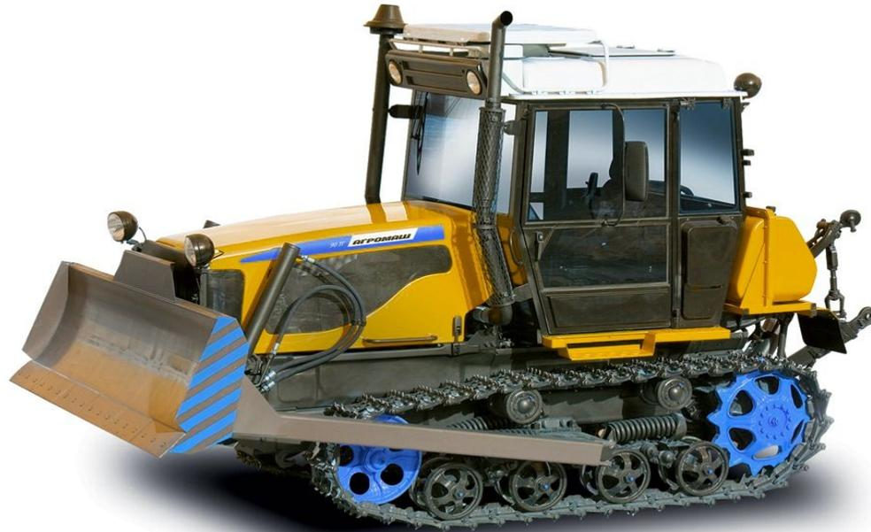
**Рисунок 1 - Трактор «Агромаш-90ТГ» с модернизируемым дизелем А-41СИ**
