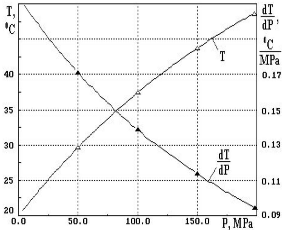
Рисунок 6 – Адиабатный разогрев дизельного топлива в результате сжатия
