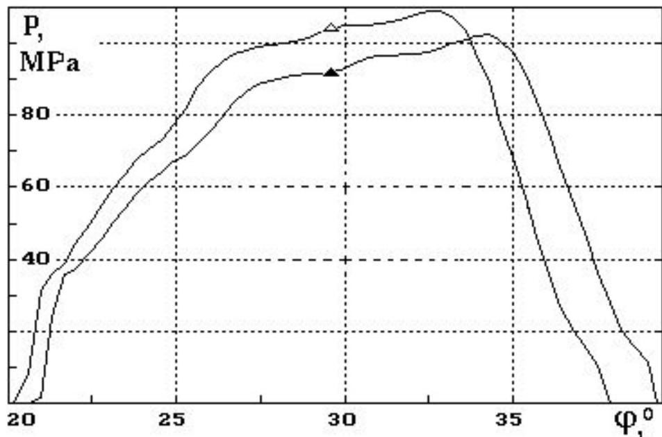
Рисунок 4 - Расчет давления впрыска в дизеле Д-49: без расчета тепловых эффектов, температура топлива и всех деталей топливной системы равна  $+30^\circ\text{C}$ ; с расчетом тепловых эффектов, температура насоса и топлива в нем  $+30^\circ\text{C}$ , температура топлива в форсунке  $+100^\circ\text{C}$ , температура форсунки  $+120^\circ\text{C}$ ;  $\varphi$  – угол поворота кулачкового вала
