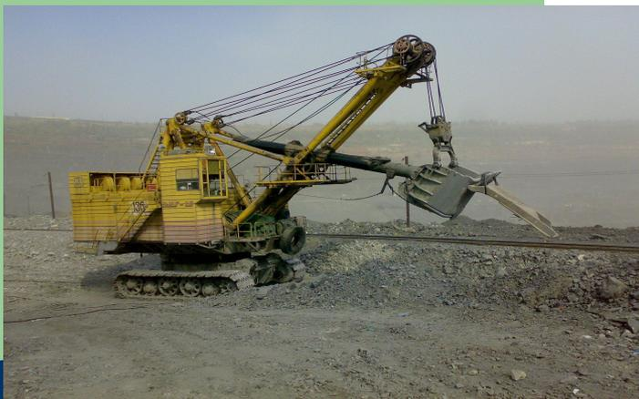
На этом экскаваторе работает Андрей Бакланов. Экскаватор ЭКГ-8 предназначен для разработки и погрузки в транспортные средства или в отвал полезных ископаемых и пород вскрыши на открытых горных работах в черной металлургии.
