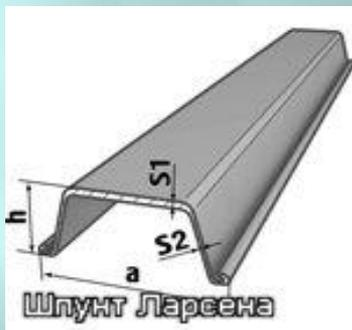
**Шпунт Ларсена** - металлический профиль, представляющий собой желоб с закруглёнными краями боковых стенок (пазами) или замками. Благодаря своей конструкции, шпунты Ларсена могут скрепляться между собой, образуя водонепроницаемую стенку. Шпунт Ларсена
