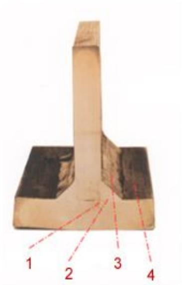
На рисунке изображен угловой сварной шов, полученный в процессе электродуговой сварки плавящимся электродом в среде газовой смеси аргон-диоксид углерода. Пластины изготовлены из углеродистой стали толщиной 8 мм
