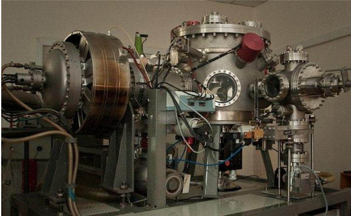
Внешний вид камеры для исследования образцов с помощью методики СРИСЭ с системой откачки до сверхвысокого вакуума
