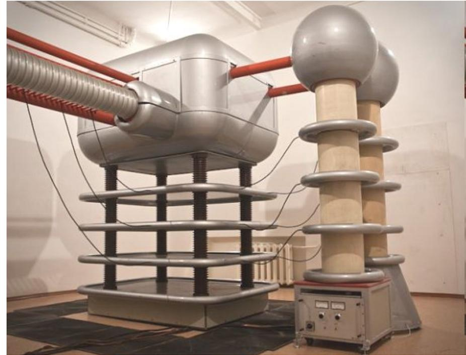
Комплекс построен на базе ускорителя НВЭЕ с энергиями анализирующего пучка ионов до 500кэВ.
