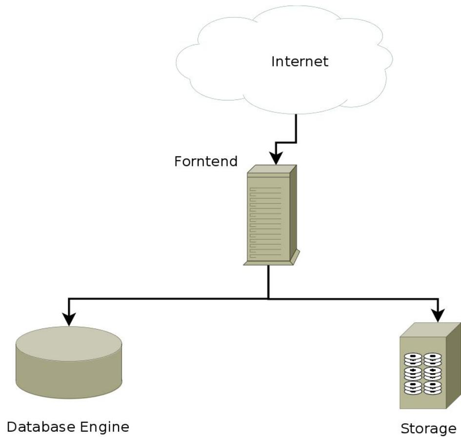
Простая схема балансировки нагрузки
