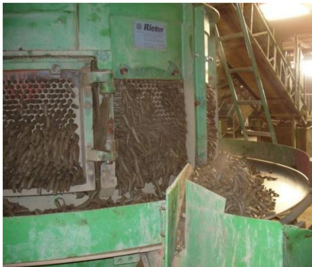
Исходное сырье для производства клинкера – натуральная сланцевая глина. Пластичная глина измельчается до размера 0,5-0,8мм., прессуется в вакуумных прессах, это исключает образование пор в полости кирпича.
