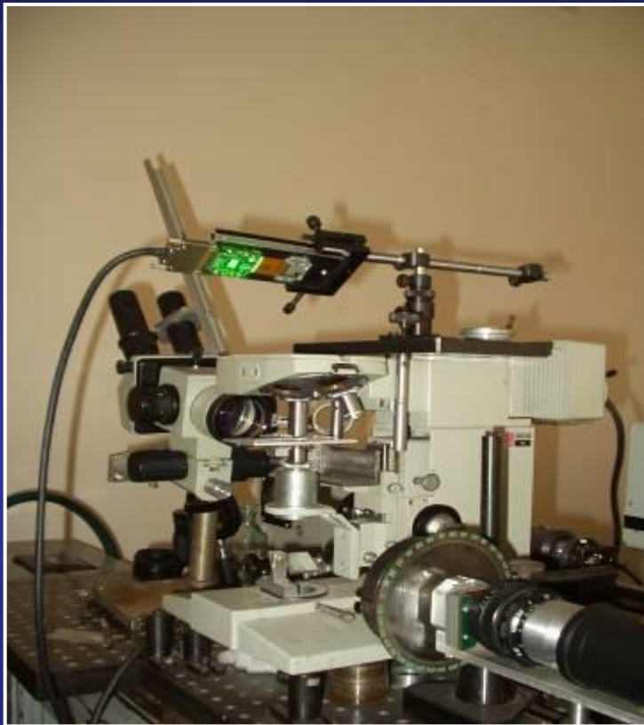
Лазерный микроманипулятор на основе оптического микроскопа и динамического жидкокристаллического микродисплея
