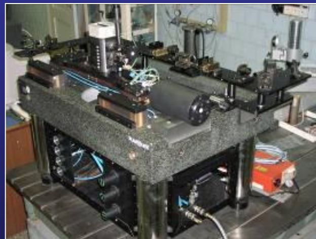
CLWS-200 (разрешение 800 нм, изображение 2000x200мм)
