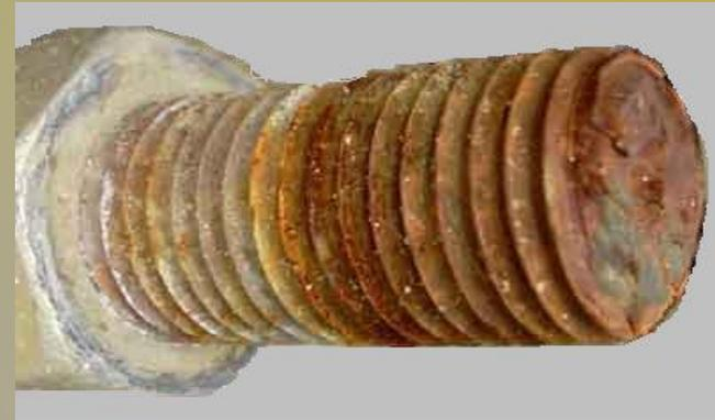
Даже само слово коррозия произошло от позднелатинского *corrosio*- разъедание. . Особенный ущерб приносит коррозия металлов. Распространенный и наиболее знакомый всем нам вид коррозии - ржавление железа. Термин “коррозия” применим к металлам, бетону, некоторым пластмассам и другим материалам. Коррозия - это физико-химическое взаимодействие металла со средой, ведущее к разрушению металла. В результате коррозии металлы переходят в устойчивые соединения - оксиды или соли.
