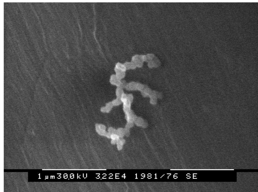
**РЭМ - изображения волокон ткани с нанесенными на волокна наночастицами меди (слева) и изображения, полученные в режиме регистрации характеристического излучения меди (справа)**
