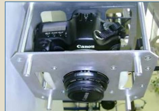
Фотокамера в монтажной раме
