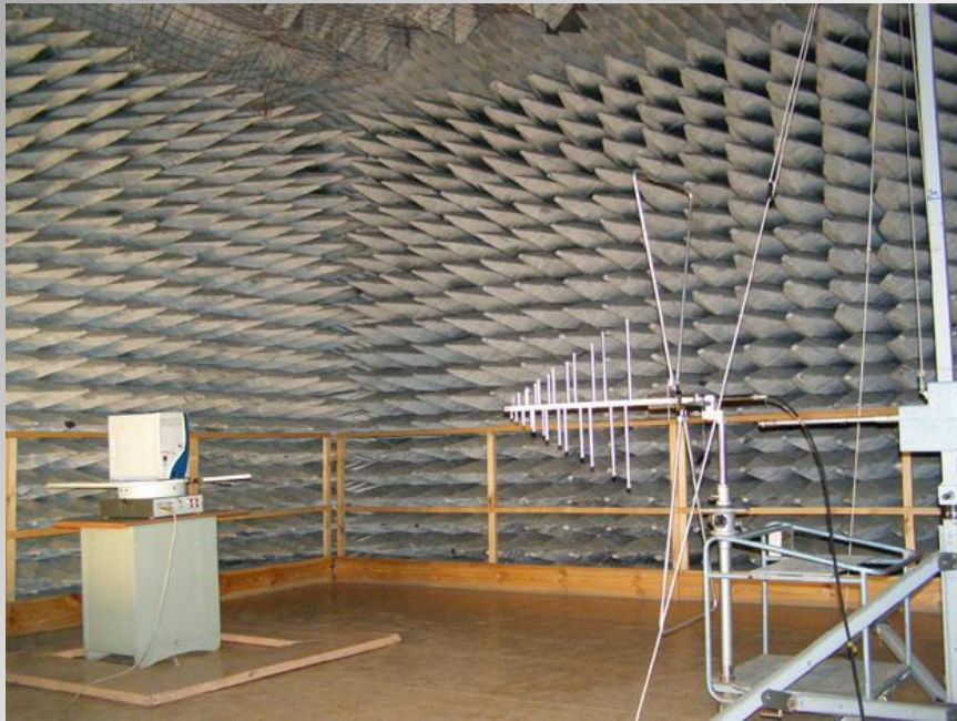
Безэховая электромагнитная камера (9*9*6 м)
