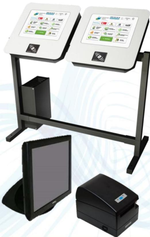
**Комплекс оборудования** для создания системы безналичной оплаты школьного питания включает в себя: сенсорные информационные панели для выбора блюд учащимися и записи на карту, выбранного заказа; устройство считывания карт и корректировки заказа; сенсорный монитор и принтер для печати выбранного заказа на чековой термоленте.
