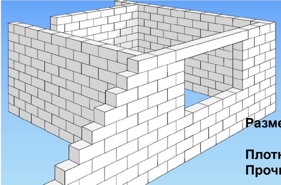
**Блок с системой паз-гребень с захватными
