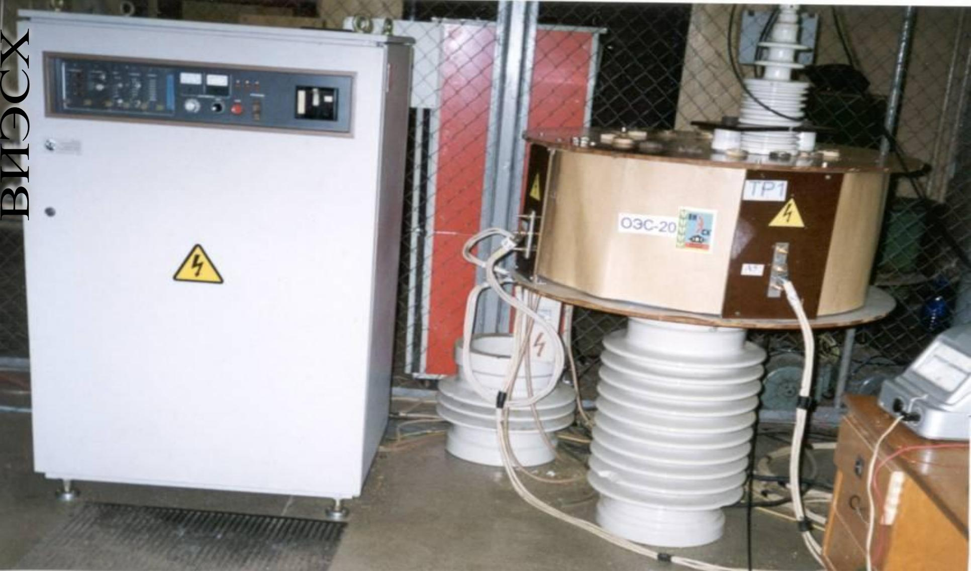
**Преобразователь частоты и резонансный контур передающего
