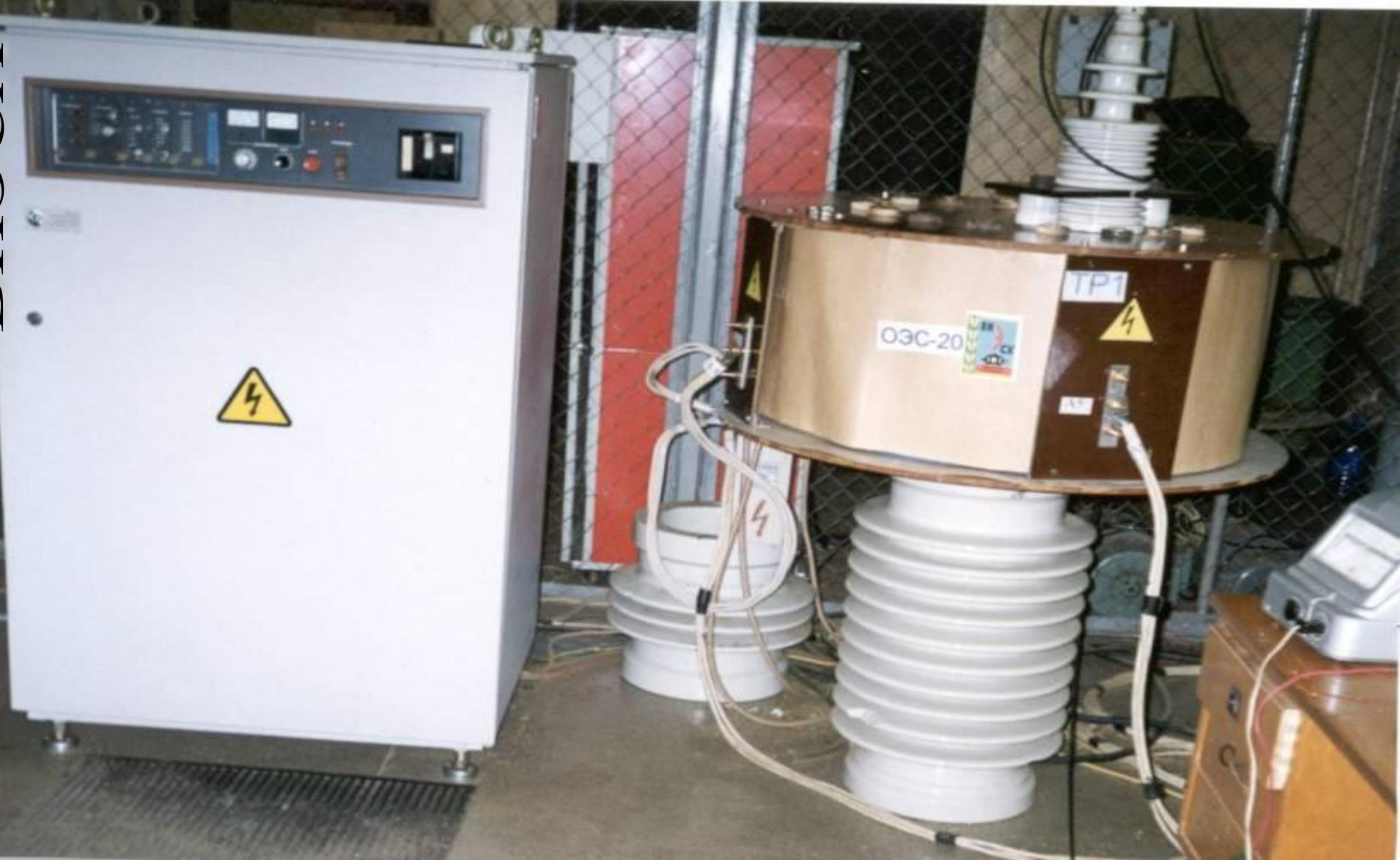
**Преобразователь частоты и резонансный контур передающего
