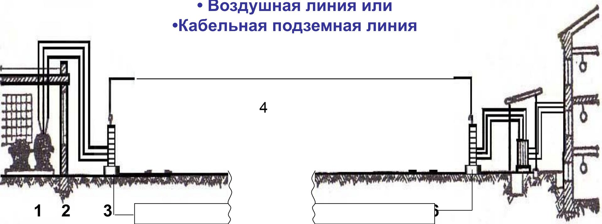
1. Электрический генератор, 50 Гц (1-100 кГц)
