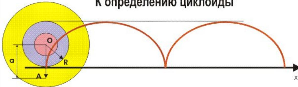
$x = a \cdot \varphi - R \sin \varphi$ ;  $R < a$  — укороченная циклоида
