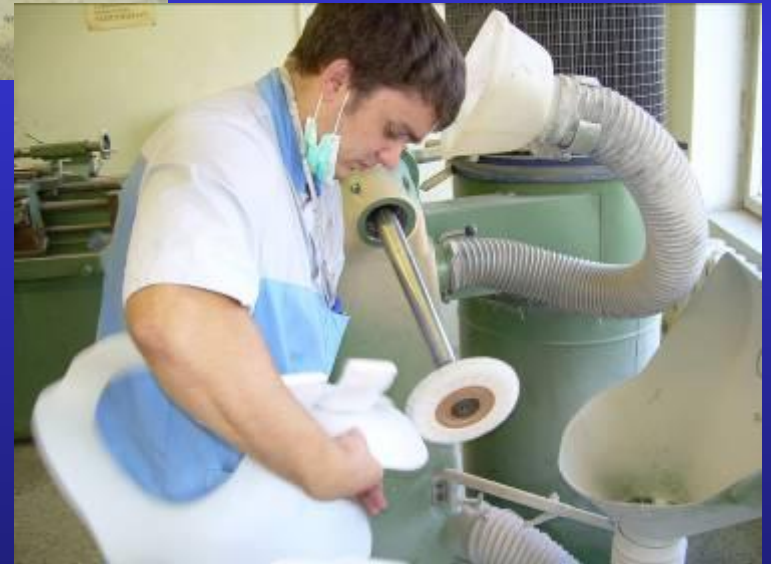
Установка крепежей, подгона, шлифовка.
