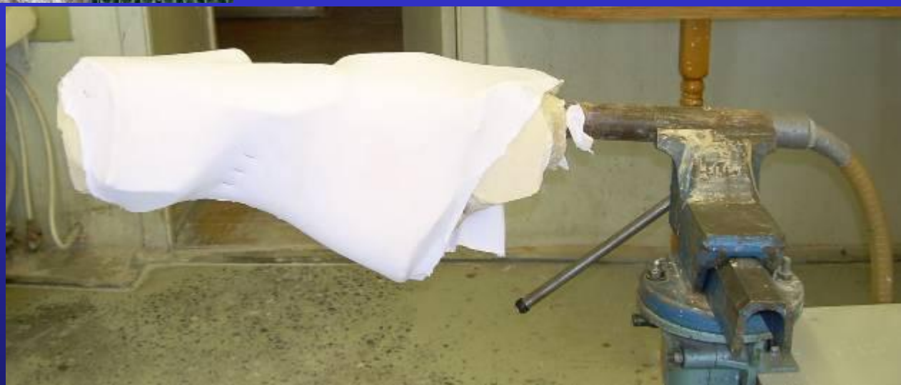
Подсоединение «позитива» к вакуумной системе.
