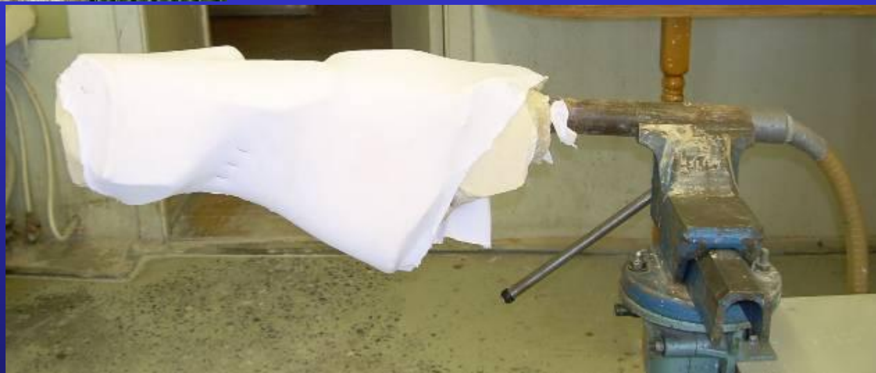
Подсоединение «позитива» к вакуумной системе.
