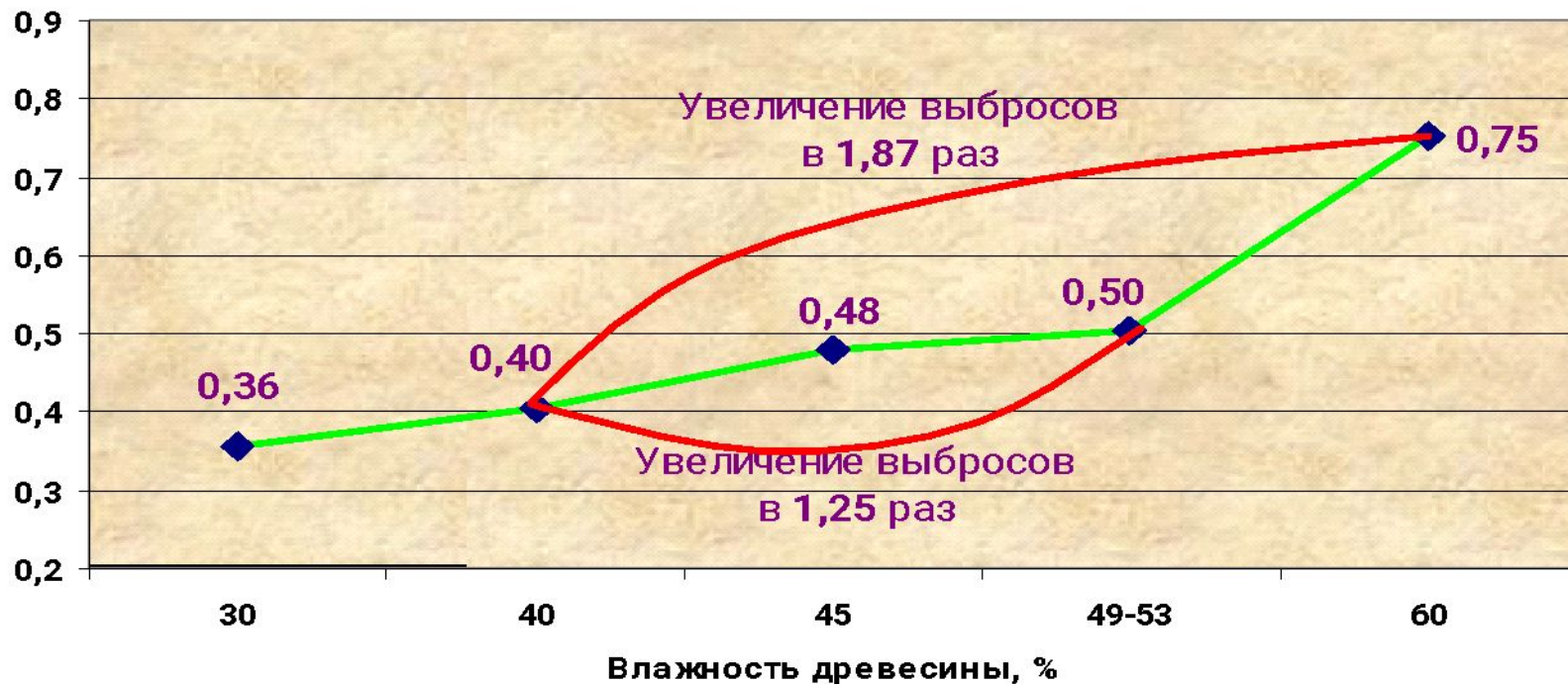
Отношение объема сухих дымовых газов и низшей теплоты сгорания топлива в зависимости от влажности топлива
