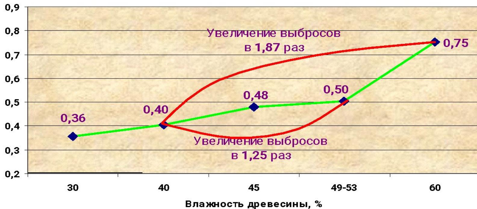
Рассмотрим подробнее, каким образом влажность топлива влияет на **коэффициент полезного действия** котла. Данную зависимость иллюстрирует следующий график, который показывает уменьшение КПД «брутто» котла при увеличении влажности топлива
