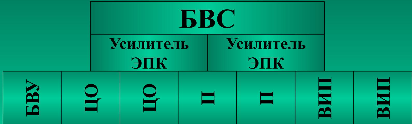
**Усилитель ЭПК-обеспечивает безопасное преобразование управляющей частоты, выдаваемой СБ в постоянный сигнал включения/выключения ЭПК;**
