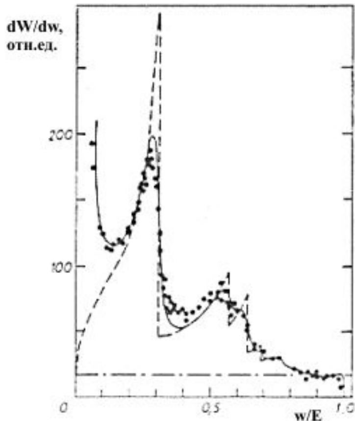
Рис. Выход когерентного тормозного излучения электронов с энергией 4,8 ГэВ в кристалле алмаза. Точки – эксперимент ( DESY, Германия ), пунктирная линия – расчет, штрихпунктирная линия – уровень некогерентного тормозного фона в аморфном углероде.
