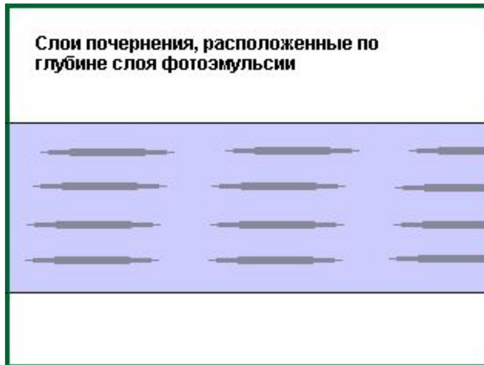
Система плоскостей почернения является встроенным фильтром
