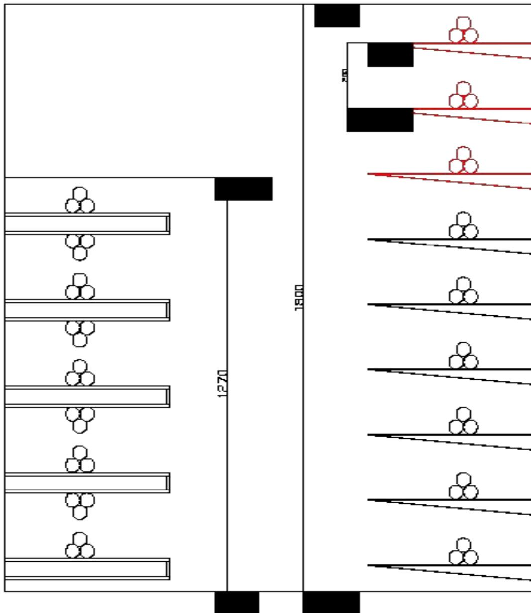
**ВЫВОД:** при заданном количестве кабелей высота эстакады уменьшается на 550 мм в каждом месте установки конструкции. Поперечное сечение эстакады можно уменьшить на 29%
