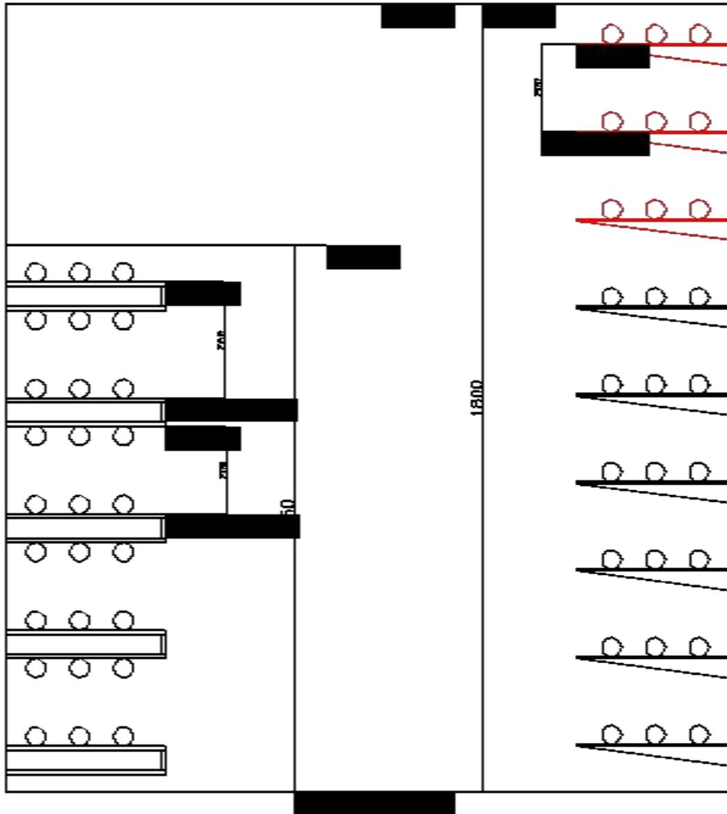
**ВЫВОД:** при заданном количестве кабелей высота эстакады уменьшается на 550 мм в каждом месте установки конструкции. Поперечное сечение эстакады можно уменьшить на 30,6%
