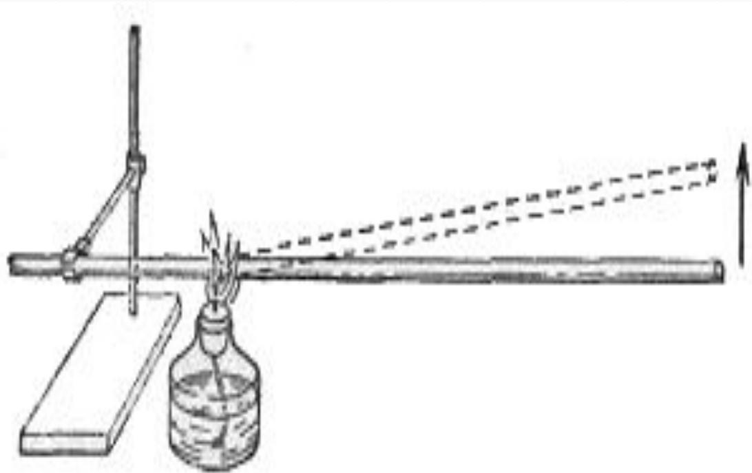
а) Пластика, склепанная из медной и железной полосок, в холодном состоянии. б) Та же пластика в нагретом состоянии (для наглядности изгиб показан преувеличенным)
