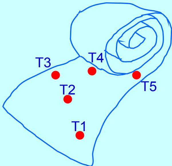
1. Входной контроль **исходного материала**, поступающего в виде полотна шириной около 1 м, длиной около 10 м, с содержанием свинца около  $0,1 \text{ г/см}^2$ , проводится согласно статистически обоснованному расчёту по 20 точкам.
