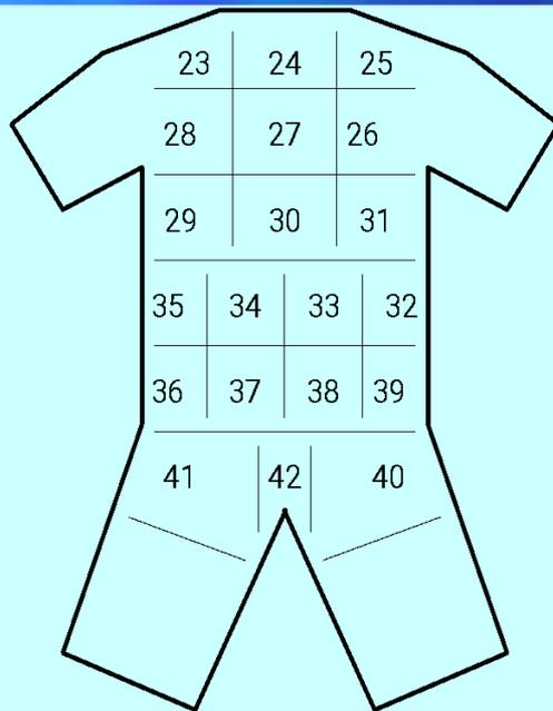
3. Сертификация **готовой продукции** сложной объёмной формы. Проверка производится в определённых точках в количестве около 40 штук. На проверку комплекта затрачивается около часа.
