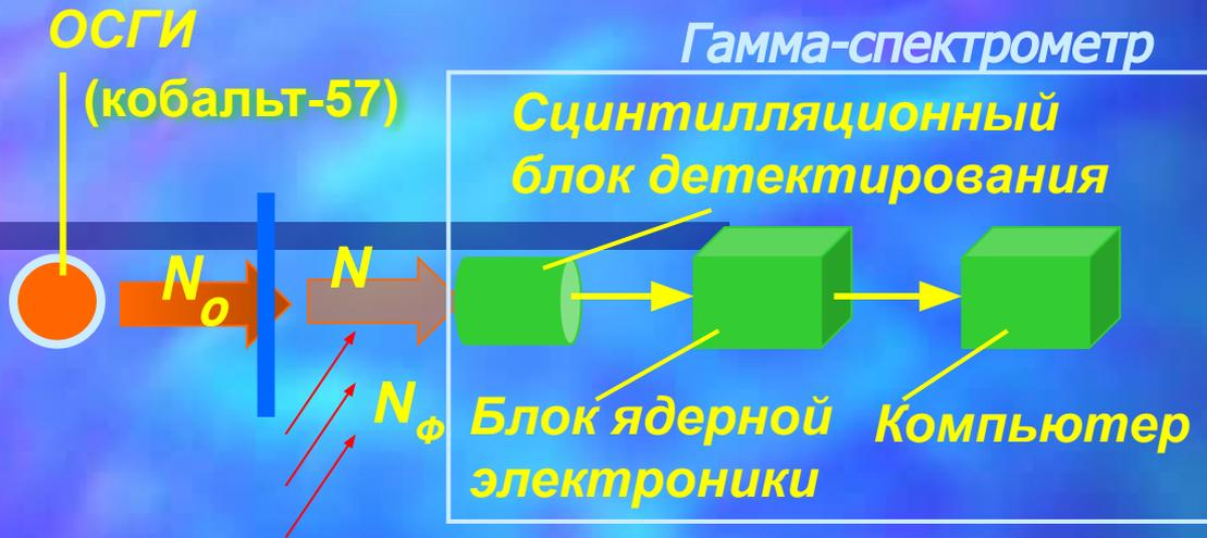
5. Конечным результатом измерений служит сумма содержимого каналов в зоне интереса. Зона интереса устанавливается симметрично относительно вершины пика с границами на уровне полувысоты пика.
