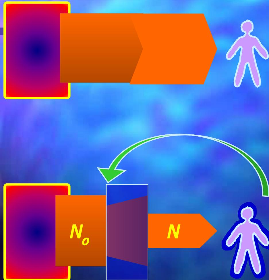
Анализ структуры радиационных полей, вызываемых облучением последствий, а также свойств материалов показал, что существует возможность снижения вредного воздействия. В этих целях были определены параметры защитных материалов (или пакетов материалов), а также принцип их распределения по телу с учётом оптимизации защитных свойств, чувствительности органов и массы изделий.
