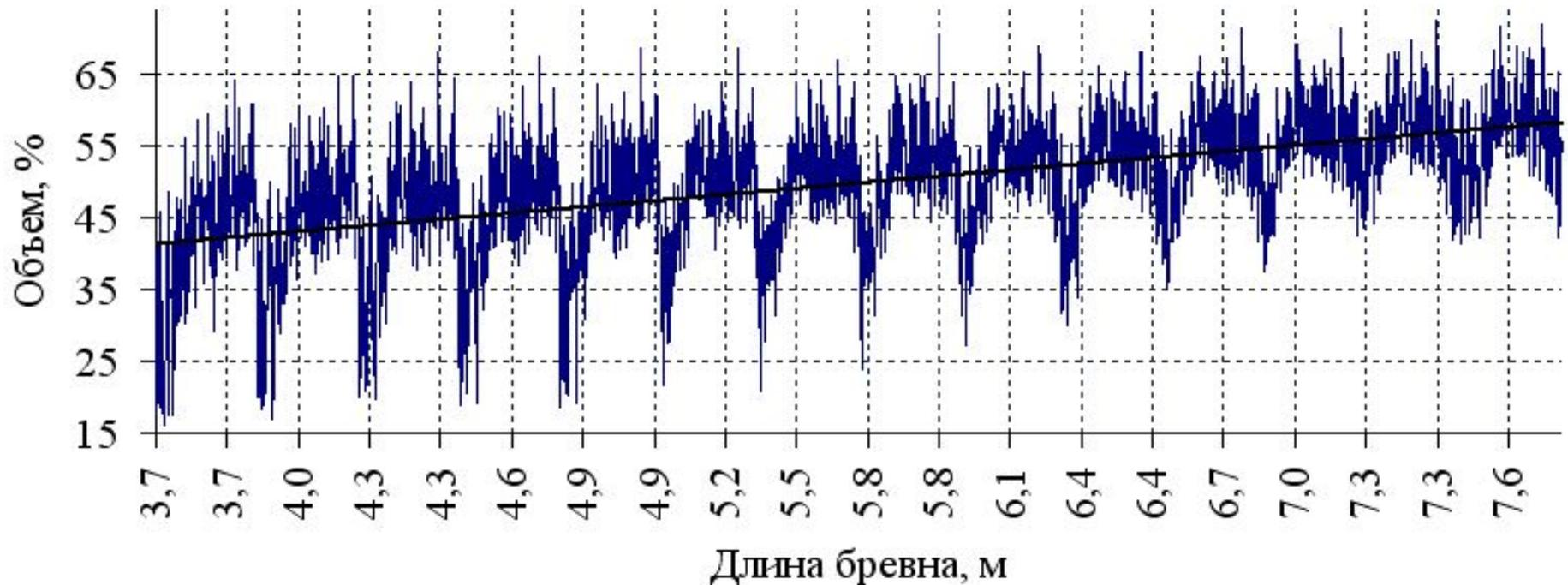
**Рисунок 16 - Зависимость объема короткомерного сырья и отрезков досок (м<sup>3</sup>) от длины и диаметра бревна при его сложной ориентации перед раскромом и ширине пропилов первого и второго проходов 2,5 мм для длины**
