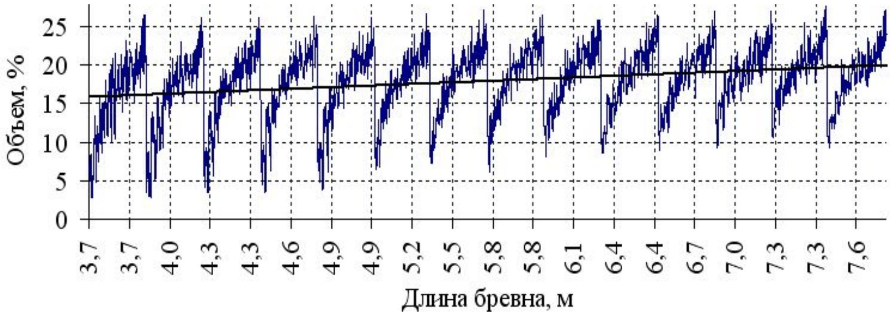
**Рисунок 10- Зависимость объема рейки (м<sup>3</sup>) от вершинного диаметра бревна при его сложной ориентации и ширине пропилов первого и второго проходов 2,5 мм при длине бревна**
