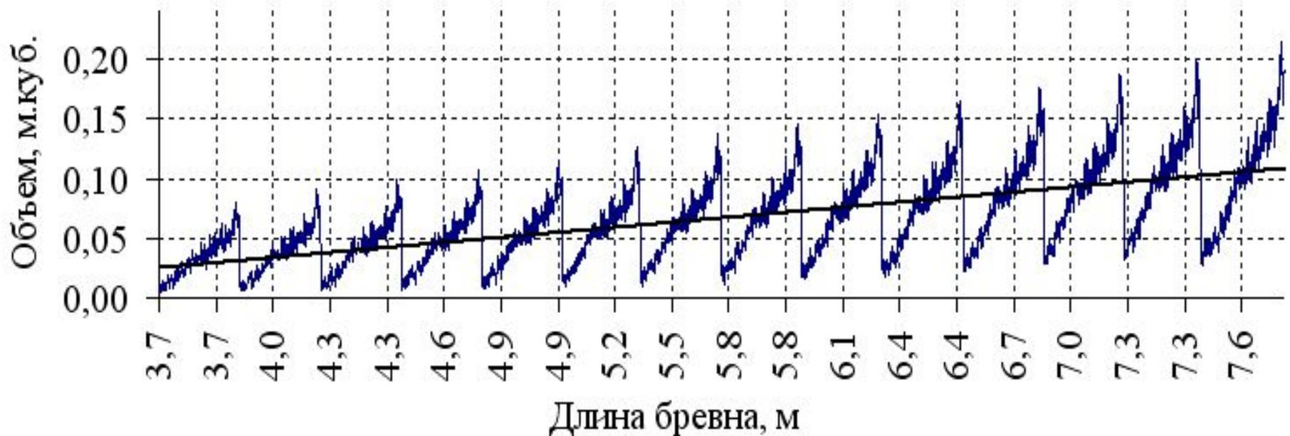
**Рисунок 15 - Зависимость отношения объема (%) короткомерного сырья и отрезков досок к общему объему отходов от диаметра и длины бревна при сложной ориентации бревна, ширине пропилов первого и второго проходов 2,5 мм**
