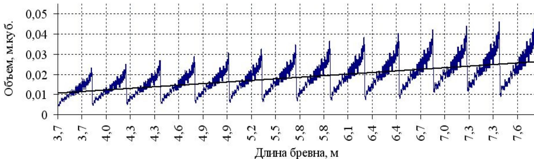
**Рисунок 21 - Зависимость отношения объема опилок к объему бревна (%) при сложной ориентации бревна перед раскроем от диаметра и длины бревна, ширине пропилов первого и второго проходов 2,5 мм**
