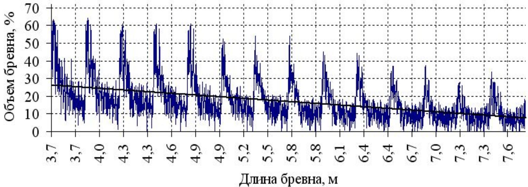
**Рисунок 4 - Зависимость объема горбыля (м<sup>3</sup>) от вершинного диаметра бревна при ориентации {x = 0.35, y = - 0.35}, при ширине пропилов первого и второго проходов 2,5 мм и длине бревна**
