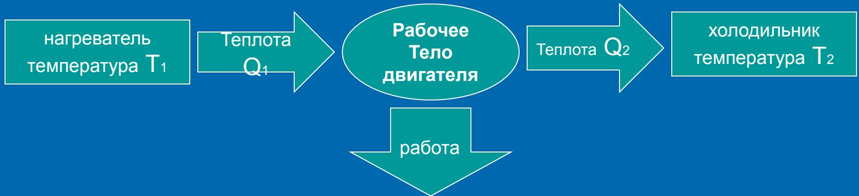
Рабочим телом двигателя является газ, т.к. газ лучше всего сжимается и расширяется при изменении температуры. Работа, совершаемая двигателем (газом)
