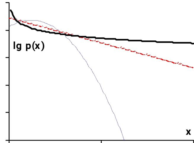
**Типичный вид плотности вероятности величин, распределенных в соответствии с нормальным, экспоненциальным и степенным законами, с различным представлением данных по осям.** Верхний график позволяет сравнить скорость спадания плотности вероятности для хвостов распределений. На нижнем левом графике (логарифмический масштаб по оси ординат) нормальное и экспоненциальное распределение представляются, соответственно, в виде параболы и прямой.
