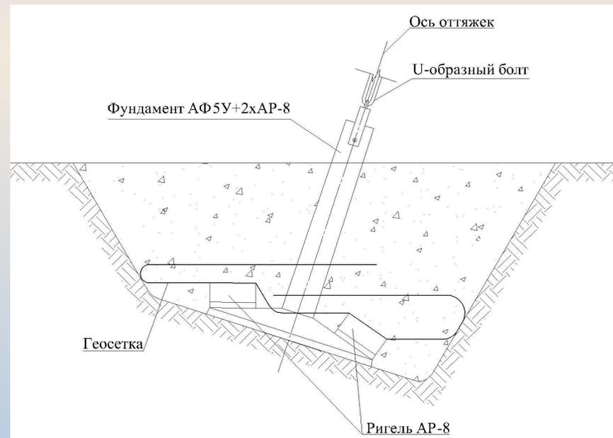
**Рис.5.** Усиленный анкерный грибовидный фундамент, установленный совместно с геосеткой.
