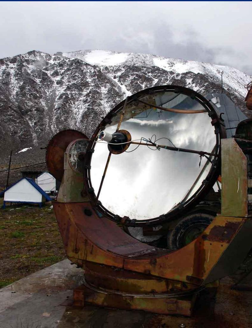
Одно параболическое зеркало диаметром 150 см с фокусным расстоянием 65 см, в фокусе ФЭУ-49Б. Ось может поворачиваться в пределах зенитных углов  $0^\circ - 110^\circ$  и азимутальных углов  $0^\circ - 360^\circ$ . Раствор конуса сбора света  $7^\circ$ .
