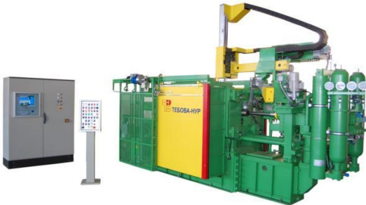
**Машина ЛПД с холодной горизонтальной камерой прессования, в базовой комплектации:**
